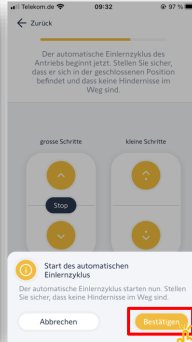
Sicherstellen, dass das Garagentor sicher öffnen und schließen kann, dann den Einlernzyklus starten (das Tor öffnet und schließt mehrmals)
